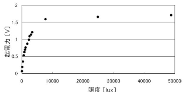
図4：照度と光電池の起電力の関係
