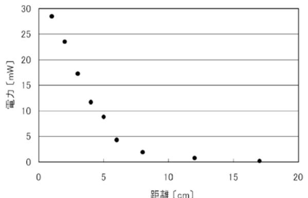
図3：光源から光電池までの距離と発電電力の関係
