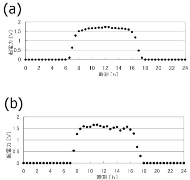
図6：1日を通した時刻と光電池の起電力の関係
