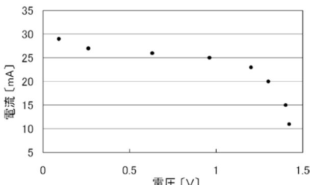
図2：光電池の電圧-電流特性
