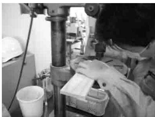
図2 木材への穴あけ作業
