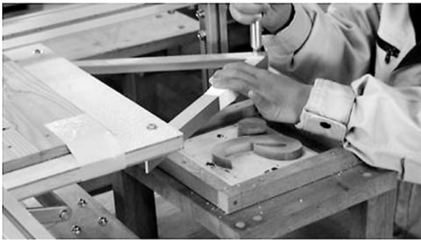
(b) ならい加工機の作業の様子
