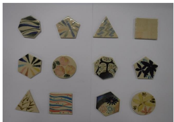
写真 12（色見本の完成：描画後、透明釉薬を掛け本焼き（1250℃）酸化焼成）
