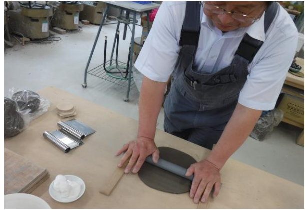
写真7(タタラ成形によるタイル制作)
