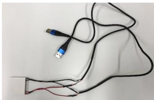
図 13 USB ケーブルを取り付けた二段重ね素子
