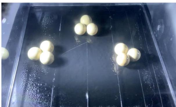
図 18 ドライアイス霧箱で観測した $\alpha$ 線の軌跡
