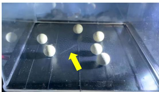
図 12 作製した霧箱で観測した $\alpha$ 線の軌跡
