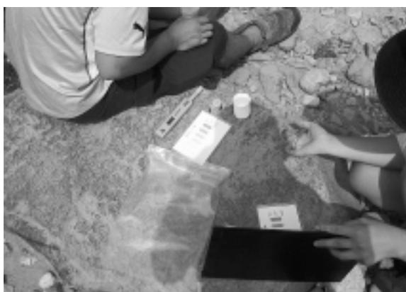
写真3 パックテストによる水質調査の様子
