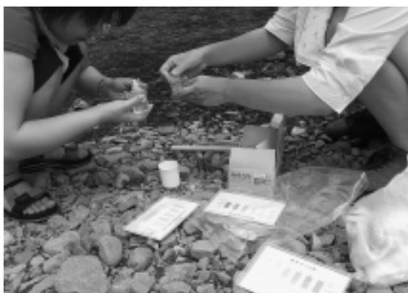
写真1 パックテストによる水質調査の様子
