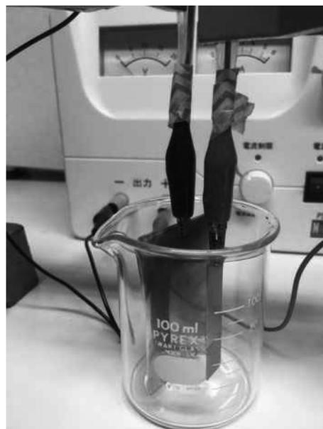
図8 電解研磨装置
