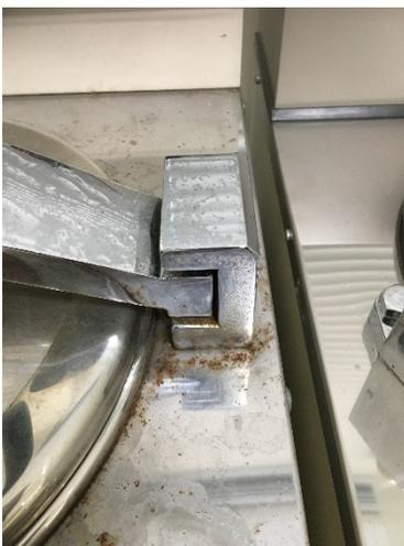
溶液を入れる場合は、容器の内部とオートクレーブの内部の圧力が変わらないように、密封せずに入れましょう。包むのはアルミホイルぐらいで完全密封しないようにしましょう。そしてしっかり蓋を閉めましょう。
