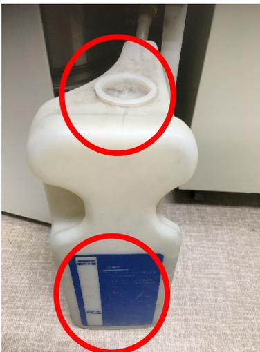
もし水がLOWより下回っている、もしくは水がHIGHを超えている場合は排水タンクをオートクレーブから取り出し、水の量を調節してください。
